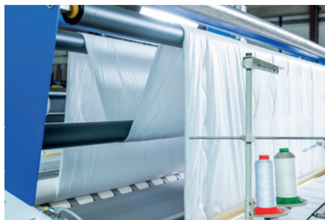
▲ Buffer integrato per alloggiamento temporaneo del materiale
