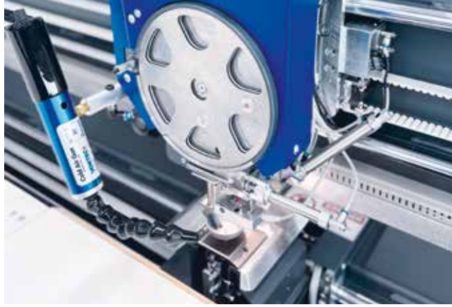
▲ Teknik açıdan zorlu malzemeler ve uygulamalar için iğneli soğutma
